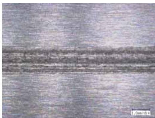
[5]-b) ハステロイ C276 試験後表面 ( × 35 )
