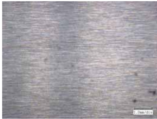
[1]-b) WC/CoCr 試験後表面 ( × 35 )
