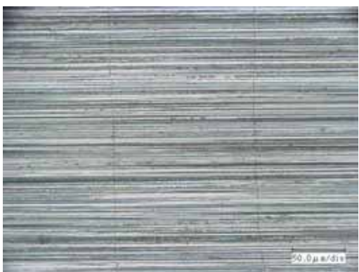
[6]-a) 硬質クロムめっき試験前表面 ( × 450 )
