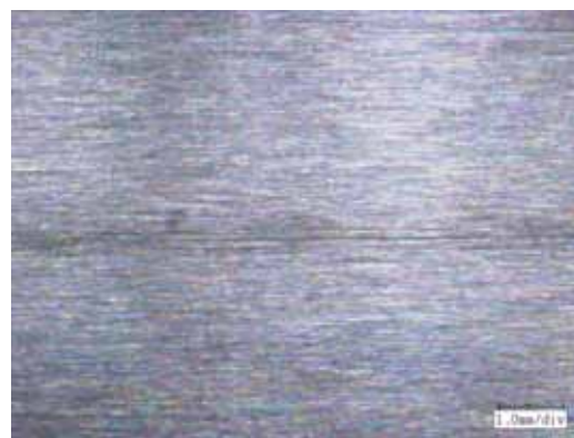
[6]-b) 硬質クロムめっき試験後表面 ( × 35 )
