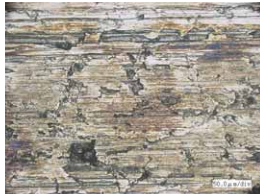
[5]-b) ハステロイ C276 試験後表面 ( × 450 )
