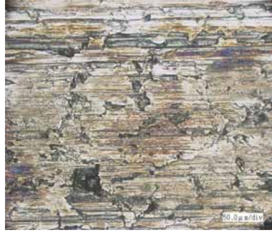
d)ハステロイ C276 試験後
