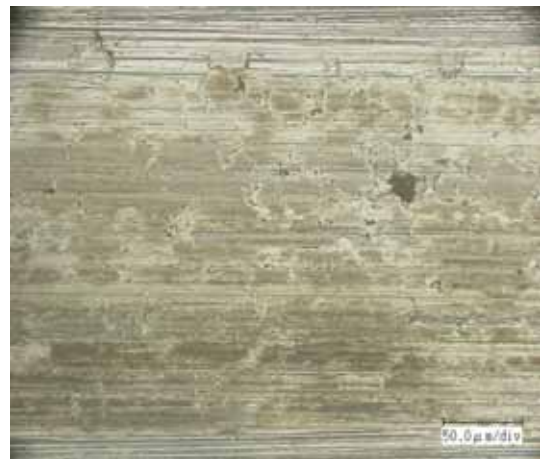
d)ハステロイ C 276 試験後
